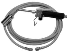
**FH 1630-S-TS1:** Набор газовой горелки для работы с термоусаживаемыми изделиями. Набор включает в себя рукоятку горелки с регулятором интенсивности пламени, насадку с диаметром сопла 38 мм и шланг высокого давления длиной 5 м, с резьбой присоединения DIN R 3/8" LH
