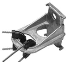
**Анкерные кронштейны CA 1500, CA 2000:** Анкерный кронштейн из алюминиевого сплава предназначен для крепления зажимов проводов основных линий. Крепится 2-мя стальными лентами (20 мм) или болтами ( $\varnothing$  14 или 16 мм).
