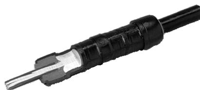
Изолированные гильзы предназначены для соединения изолированных многопроволочных AI и СИ проводов. Провода со снятой изоляцией вводятся в гильзу до перегородки и прессуются по разметке матрицами E140 через изоляцию гильзы. Электрический контакт и герметизация с помощью эластомерного кольца обеспечиваются в процессе опрессовки. Длина всех гильз 70 мм.
