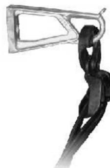
Промежуточные поддерживающие зажимы предназначены для крепления изолированной несущей нейтрали СИП до 1 кВ. Нейтраль фиксируется регулируемым зажимом. Подвижное соединение позволяет зажиму двигаться в продольном и поперечном направлениях.
