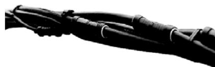
Соединители предназначены для изолированных многопроволочных алюминиевых проводов. Имеется три типа соединителей с разными механическими нагрузками для самонесущей системы СИП и СИП с несущей нейтралью. Провода со снятой изоляцией вводятся в гильзу до перегородки и прессуются по разметке, через изоляцию гильзы. Электрический контакт и герметизация с помощью эластомерного кольца обеспечиваются в процессе опрессовки. Длина соединителей – 100 мм, а для несущей нейтрали – 170 мм.
