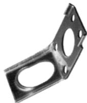
**Анкерный кронштейн CAB 25:** Анкерный кронштейн из нержавеющей стали предназначен для крепления зажимов проводов абонентов. Крепится стальной лентой (20 мм), болтом ( $\varnothing$  14 или 16 мм) или 4 шурупами ( $\varnothing$  5 мм).
