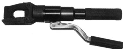
**SIMABLOC 55:** Ручной гидравлический пресс со сменными матрицами (типа 4E и 5E) для сечения провода до 95 мм<sup>2</sup> и максимальным усилием 5000 кгс
