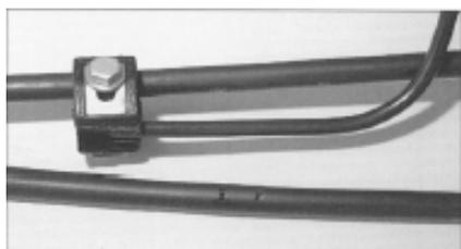
Провода и кабели с поврежденной изоляцией, например, после снятия прокалывающего зажима.
