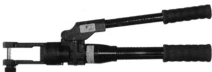
**SIMABLOC 80:** Ручной гидравлический пресс со сменными матрицами (тип 7E, HEL-676xx) для жил сечением до 150 мм<sup>2</sup>, макс. усилие опрессования 7000 кгс
