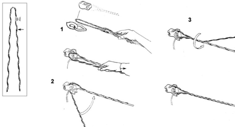
Зажимы натяжные спирального типа ASDE предназначены для анкерного крепления голых алюминиевых жил и обеспечивают высокую механическую прочность заделки (до 90% от разрывного усилия провода) на небольшой длине, при соблюдении других преимуществ спиральной технологии:
