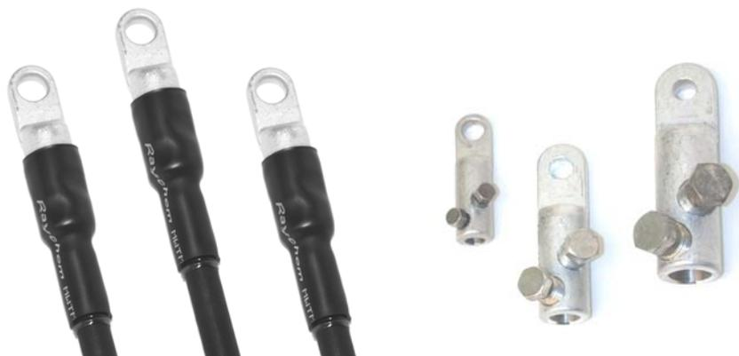
Механические болтовые наконечники применяются для оконцевания медных и алюминиевых, однопроволочных и многопроволочных жил. Перед установкой наконечника следует снять изоляцию провода. Болты вворачиваются ключом с накидной головкой до срыва головки.
