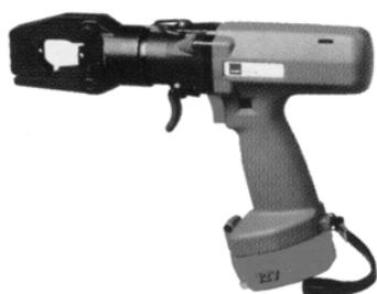
**AUTOPRESS 55+BAT+CH+CR:** Аккумуляторный гидравлический пресс со сменными матрицами (типа 4E и 5E) для сечения провода до 95 мм<sup>2</sup> и максимальным усилием 5000 кгс, поставляется с чемоданом, аккумуляторной батареей и зарядным устройством
