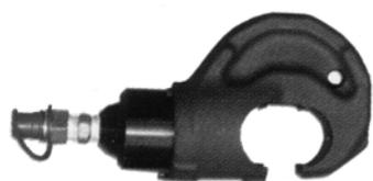
**V120C+CM+coffret:** Головка гидравлического пресса со сменными матрицами (тип 12SE, 12R) для жил сечением до 240 мм<sup>2</sup>, макс. усилие опрессования 12000 кгс. Поставляется с шаровым штуцером. Насосы SOLHYFLEX или AUTOPUMP заказываются отдельно
